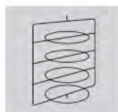
Anaquele de 4 parrillas circulares ▲ (con capacidad máx. de bandejas de 15" (381 mm))
